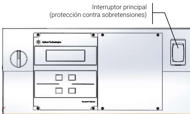
Figura 45 Activación del sistema
